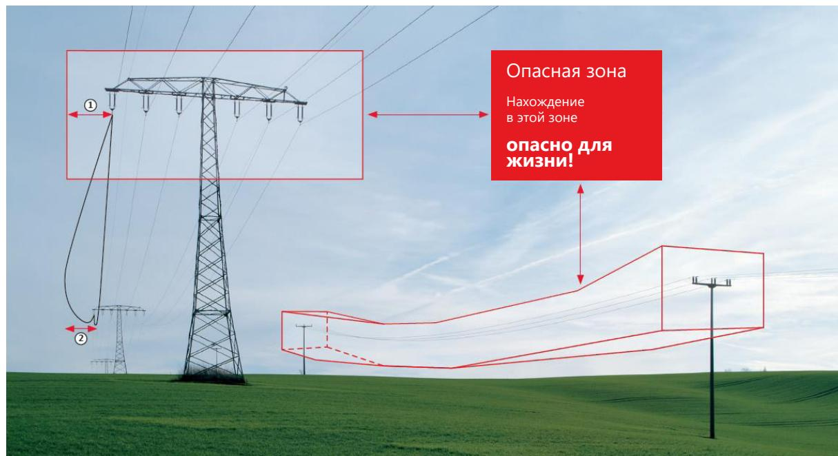
**ВНИМАНИЕ: решающее значение имеет расстояние до раскачивающегося провода!**
